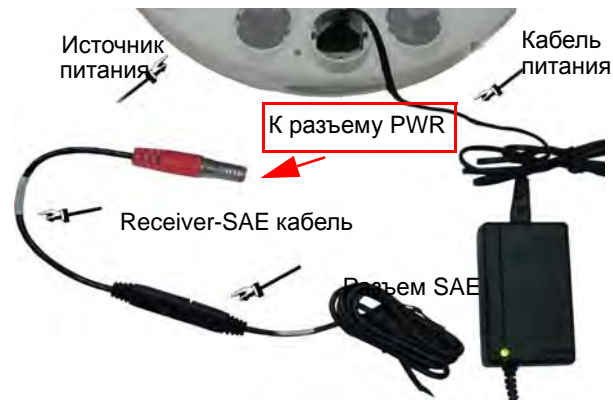
Рисунок 20. Подключение питания к приемнику ТРИУМФ-1
