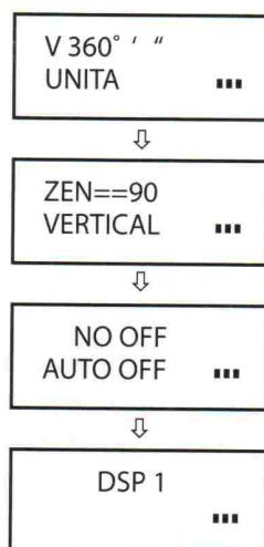
(5) Настройка датчика вертикального угла:
