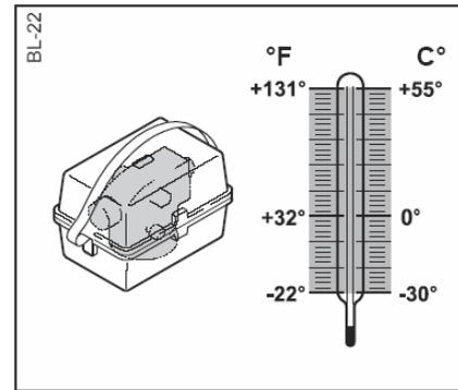
При хранении прибора, особенно летом и в транспорте, не забывайте о диапазоне допустимых температур при хранении: от  $-40^{\circ}\text{C}$  до  $+70^{\circ}\text{C}$ .
