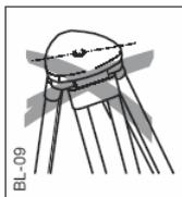
При установке штатива обращайтесь внимание на то, чтобы головка штатива была горизонтальна. Значительный наклон штатива должен корректироваться с помощью подъемных винтов трегера.
