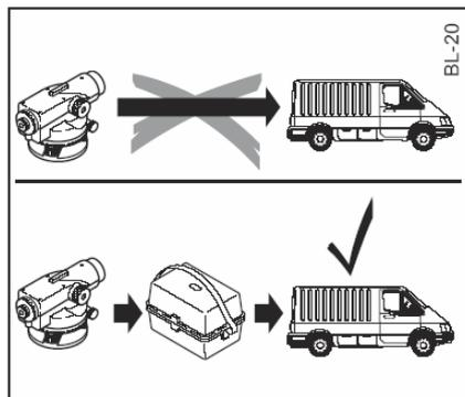
Никогда не перевозите прибор в автомобиле без транспортировочного футляра. Прибор может быть поврежден вследствие ударов и вибрации.
