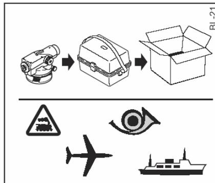
При перевозке прибора на поезде, в самолете или на корабле всегда используйте оригинальную упаковку (транспортировочный футляр и картонную коробку).
